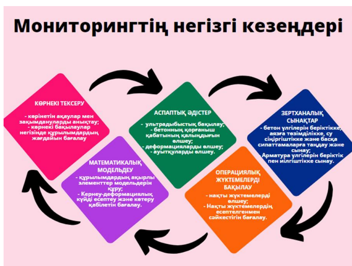
Сурет 4. Тұрғын үйлердің темірбетон конструкцияларының эксплуатациялық сенімділігін анықтау мониторингі әдістемесінің негізгі кезеңдері
