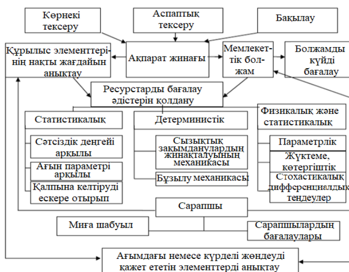
Сурет 1. Тұрғын үй ғимараттарының темірбетон конструкцияларының эксплуатациялық сенімділігін бақылау жүйесі
