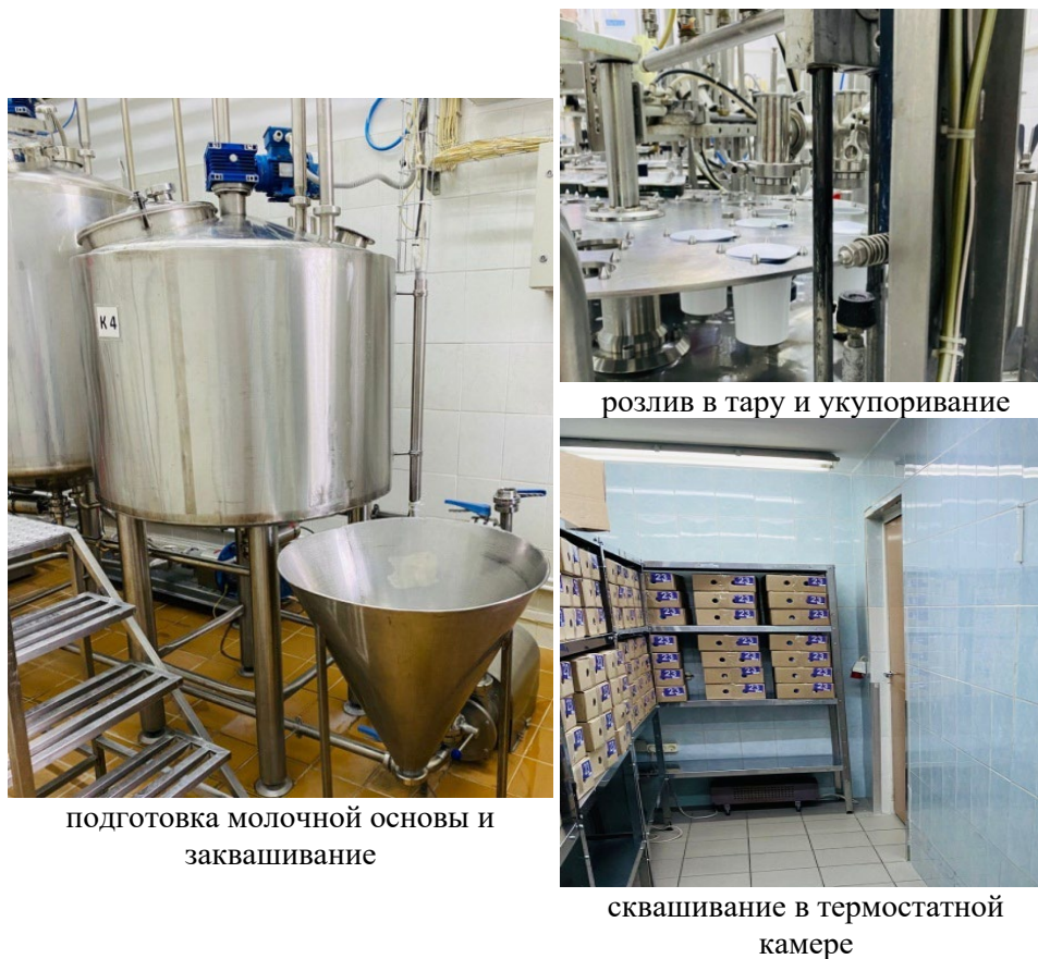
Рис. 1. Аппаратурное оформление процесса производства кисломолочного десерта на основе козьего молока
