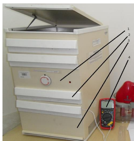
1 – ИҚ кептіргіші; 2 – сөре; 3 – негізі; 4 – термометр.
