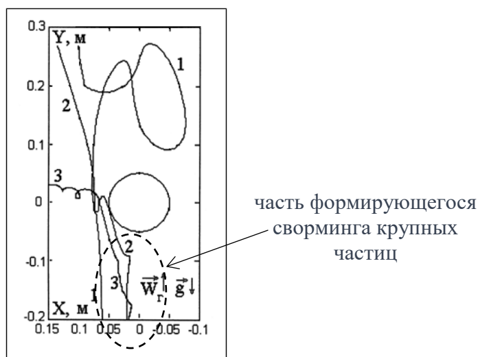
Рис. 2. Пути движения частиц в условиях нестационарного вихревого следа с частицами различного диаметра: 1 – 2 \times 10^{-4} м, 2 – 5 \times 10^{-4} м, 3 – 7 \times 10^{-4} м; диаметр цилиндра D_{cyl} = 0.2 м; средняя скорость газового потока W_g = 3 м/с.
