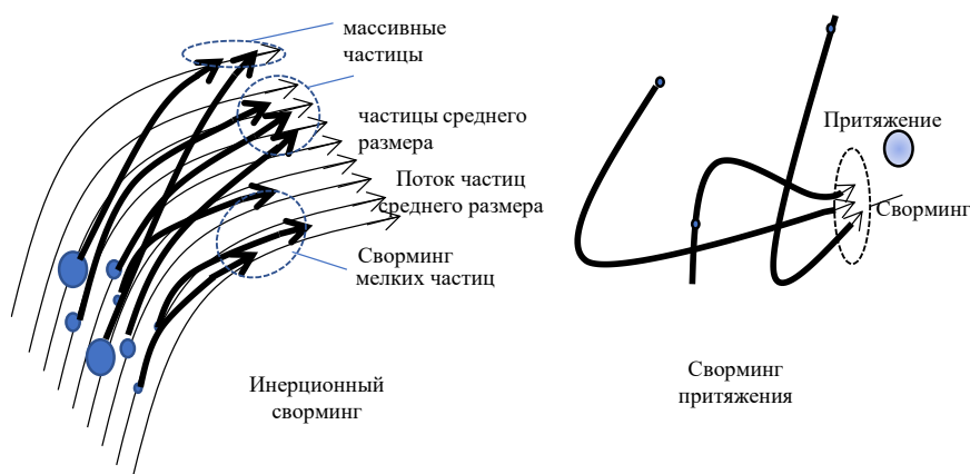
Рис. 1. Картина поведения частиц дисперсной фазы при различных типах роения: инерционное, аттрактивное
