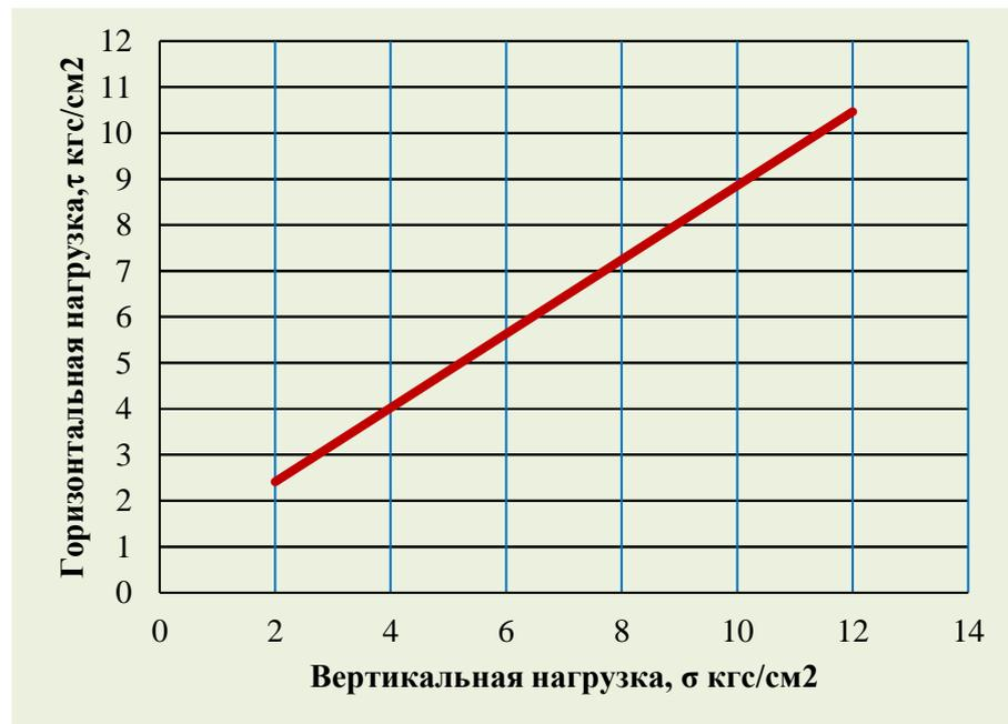
Рис.4. График зависимости  $\tau=f(\sigma)$
