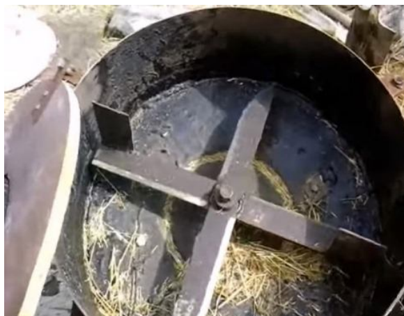
Сурет 2. Жару әдісімен эксперименттік ұнтақтағыш құрылым
