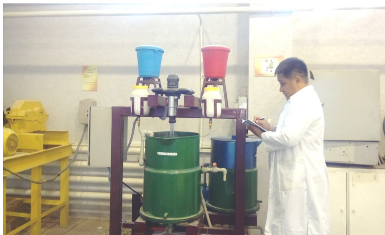
Сурет 2. Парафинді композицияларды алуға арналған стандарты емес жабдық
