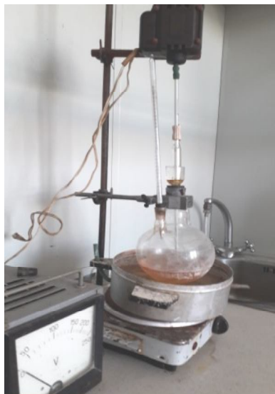
Сурет 1. Парафинді композицияларды алуға арналған зертханалық құрылғы
