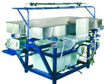
Сурет 1. S12-MkII Гидрологиялық және арналық үдерістерді зерттеуге арналған қондырғы
