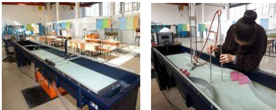
Сурет 10. S2-4M-A ашық арнадағы ағын қозғалысына көзбен бақылау үшін арналған эксперименталдық қондырғы
