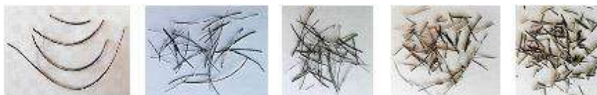
Рис. 3. Стружки полученные при обработке отверстий инструментом, оснащенным чашечным резцом с наплавкой из материала STOODY M7-G
