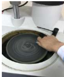
Сурет 7. Үлгілерді ажарлау үрдісі
