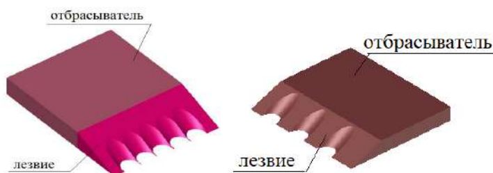
Рис. 6. Предлагаемый нож для обхвата стебля камыша
