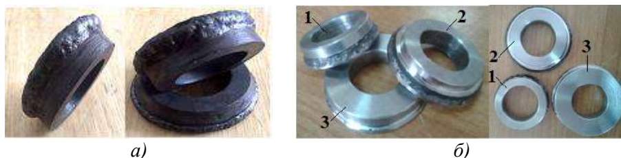
а - наплавленные чашечные резцы; б - готовые чашечные резцы после механической обработки; 1 – Ø50 мм; 1 – Ø70 мм; 1 – Ø80 мм
