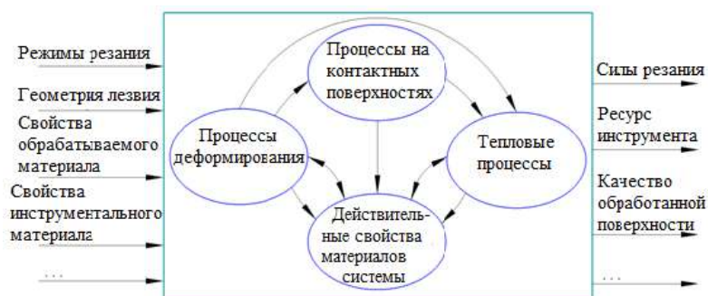
Рис. 1. Физическая модель процессов в зоне стружкообразования
