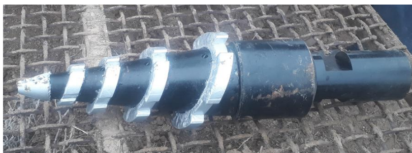
Рис. 2. Фотография опытного образца комбинированного бура «сверло-фреза»
