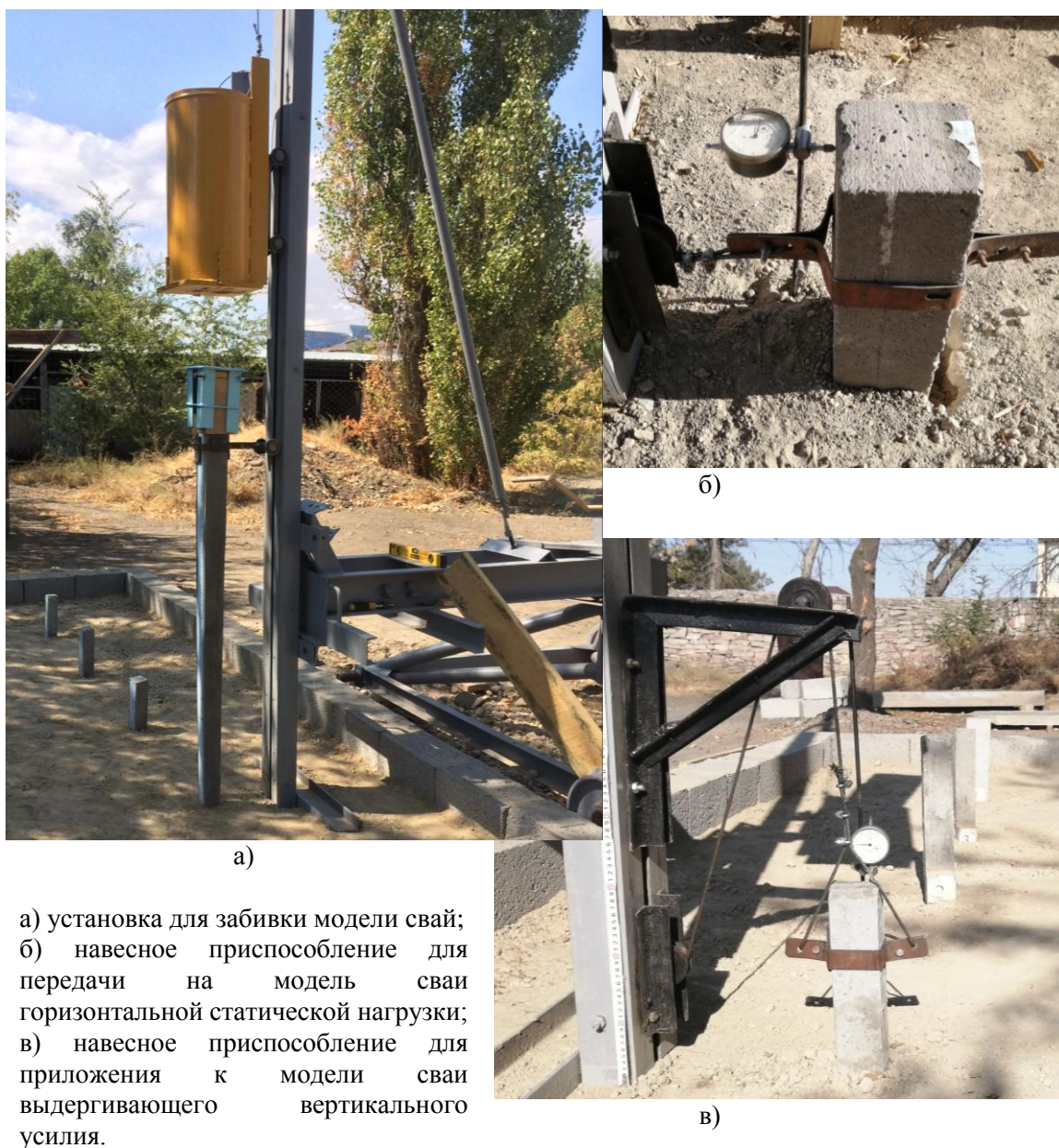
Рис. 1. Общий вид оборудования для забивки и испытаний крупномасштабных моделей свай
