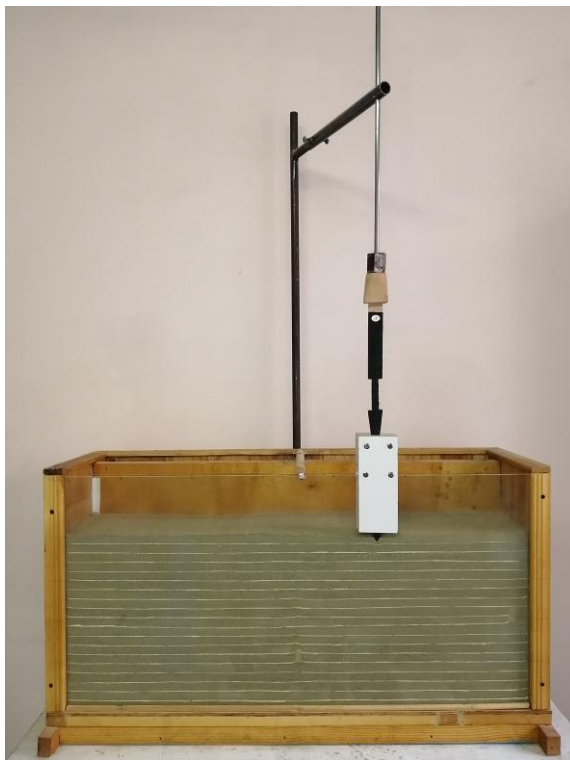
Рис. 1. Лоток и навесное устройство для забивки плоских моделей свай
