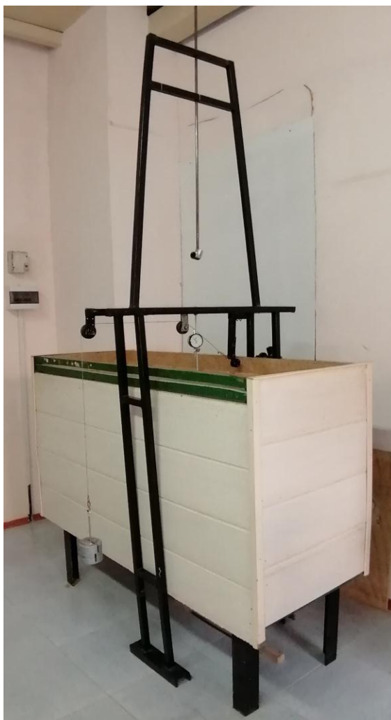
Рис. 3. Пространственный лоток и навесное оборудование для забивки и испытаний маломасштабных моделей свай
