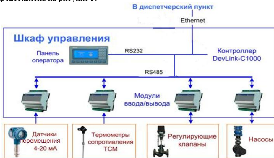
Рис. 3. Схема подключения датчиков перемещения к котроллеру
