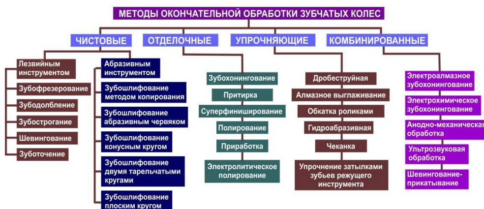
Рис. 1. Классификация методов финишной обработки зубьев зубчатых колес
