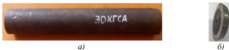
Рис. 2. Образец из стали 30ХГСА (а) и фрикционная фреза, изготовленная из стали HARDOX 400 (б)
