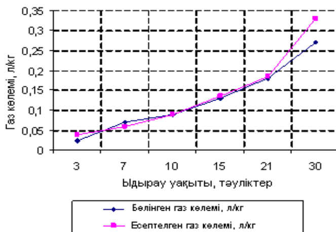
Сурет 1. Метан пайда болу көлемін есептеу және эксперимент жүзінде салыстыру
