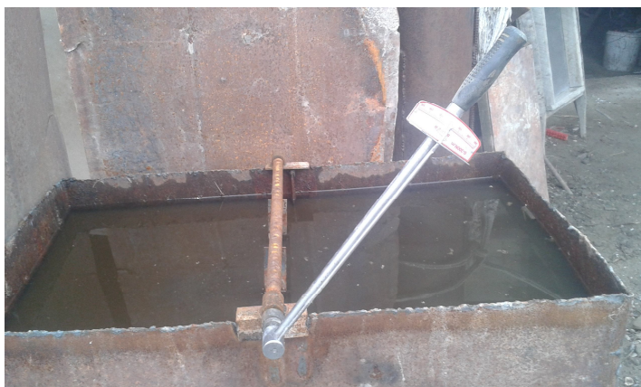
Сурет 2. Стандартты динамометрлі кілтпен білікті бұрау
